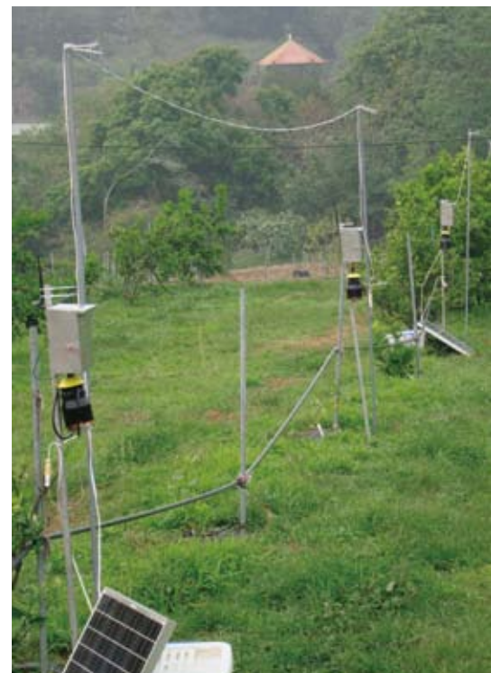
大範圍監測時，通常對感測器節點採階層式管理，透過無線傳輸把蒐集到的數據傳送給下一層節點，不斷接力傳遞至田間閘道器彙整。
