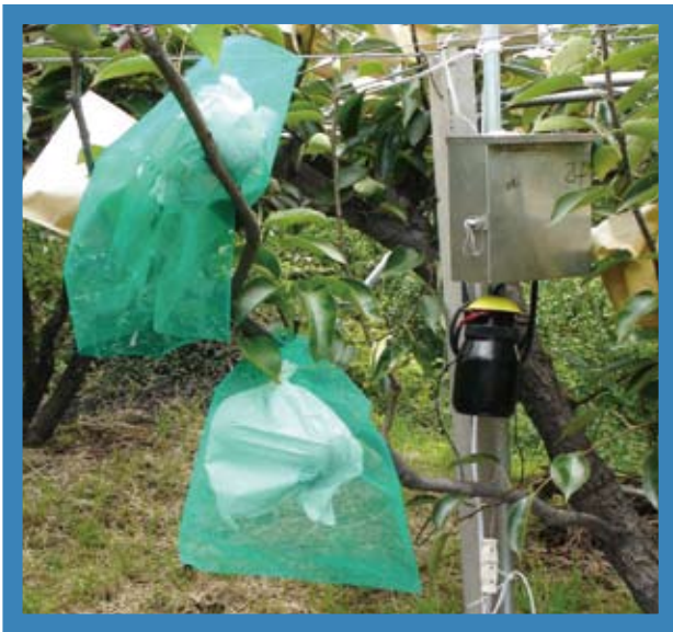
感測器節點上的感測器能測量溫度、溼度、照度等環境參數，還配置有自製的自動化誘捕裝置，對捕捉到的東方果實蠅計數。這些資訊可以找出東方果實蠅的活動熱點及建立生態模型，提供給農民及研究人員參考。
